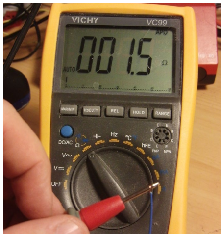
Kuva 3. Yleismittari näyttää, että johdon päät ovat yhteydessä.
